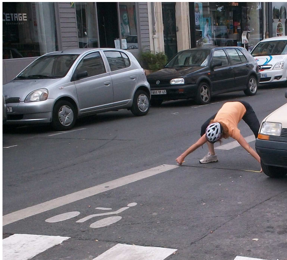
Un des enquêteurs de l'association en train de mesurer la largeur d'une bande cyclable
